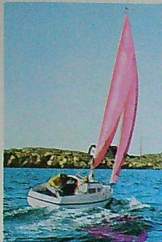
Monarks nya Varianty är en ruffad JOG-kryssare i glasfiberarmerad plast. Båten är närmast att betrakta som en ruffad version av Avanti, därav namnet.
