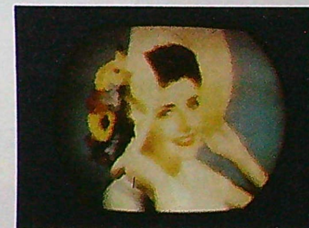
Här ser vi slutresultatet, en ganska snygg additiv blandning av de ovanstående bilderna. Jämför den svartvita bilden på föregående sida.
