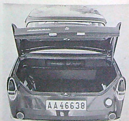
Bagageutrymmet är förvånansvärt rymligt för bilens storleksklass. Reservhjul och verktyg förvaras i vänster bakflygel. Det enda man skulle kunna önska sig är en lägre tröskel
