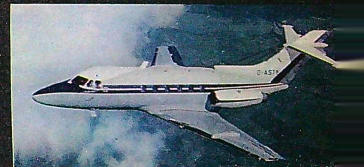
"Affärsmannaplanet" Hawker Siddeley 125 har blivit en av de tiska flygindustrins lyckokast. Hittills har 103 exemplar sålts av lilla jetplan, som har motorerna akterplacerade på Caravelle-r Planet tar 6—8 passagerare och har två Bristol Siddeley motorer.
