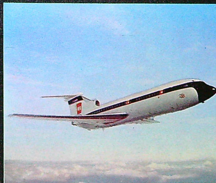
Engelska flygbolaget BEA har nu beställt 15 Hawker Siddeley Trident av den nya versionen 2E. Trident 2E har tre Rolls-Royce Spey-motorer, tar 109 passagerare och räckvidden är tillräcklig för nonstop-flygningar London—Mellersta Östern.
