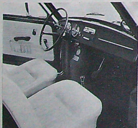
Framsätet i DAF är förvånansvärt rymligt. På golvet framför stolarna sitter väljarspaken för framt och back. Instrumentbrådan är överskådlig men har bristande detaljplanering.
