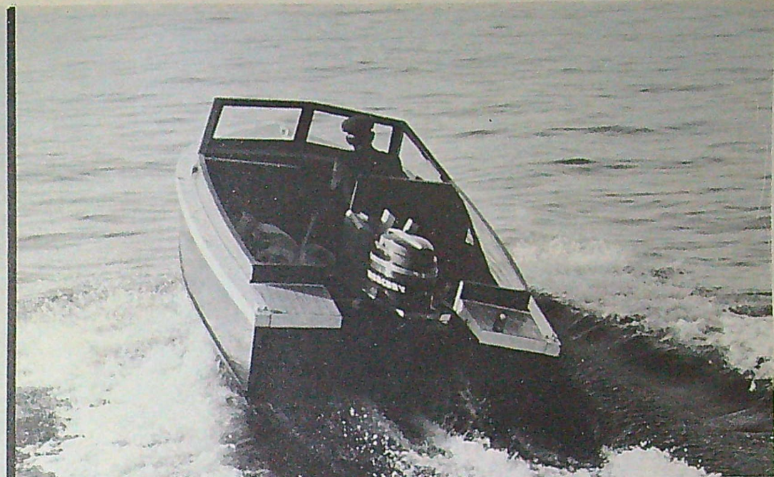
Mercury Merc 500 är en ettrig motor i sin klass och gav goda fartvärden vid vårt prov. Testbåten — t h — har rätt djup V-botten med steglister och är mer att betrakta som snabb allroundbåt än utpräglad fartbåt.
