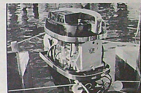
Motorn blir tillgänglig för inspektion sedan det för Mercury typiska "midjebandet" lyfts av. Kåpan sluter tätt intill motorkroppen och åtkomligheten är inte alltid den bästa.
