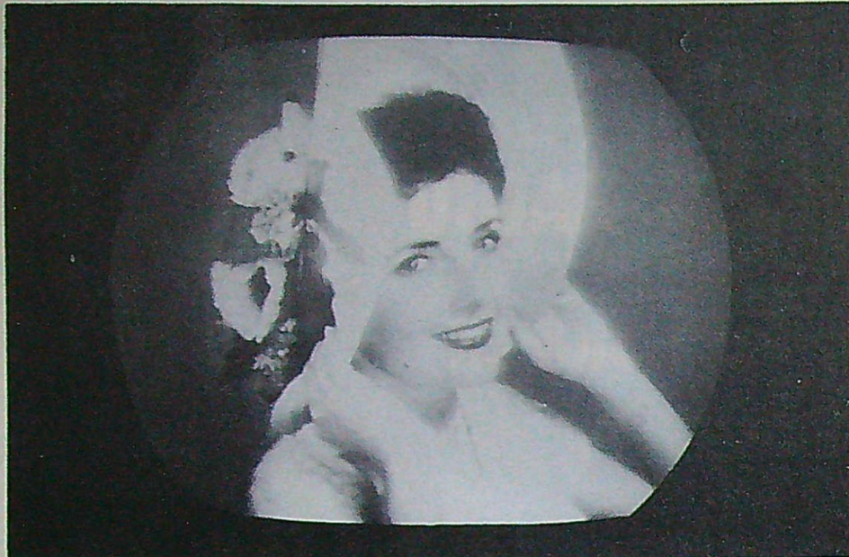
Denna bild visar hur en färgbild ser ut i en svartvit mottagare, om överföringssystemet är kompatibelt, dvs möjliggör svartvita bilder i färgmottagare och vice versa.
