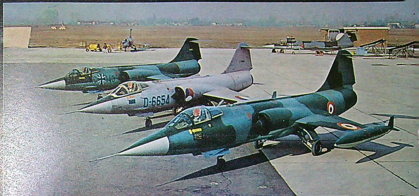
Lockheed F-104 Starfighter har byggts i stort antal för både USA:s flygstridskrafter och för NATO-ländernas flygvapen. Detta snabba överplan — toppfart 2,2—2,3 Mach — finns både i jakt-, skol- och fotospaningsversion. Planet licensbyggs av Fiat i Italien och bilden visar F-104 med italiensk (närmast), holländsk och tysk nationalbeteckning.
