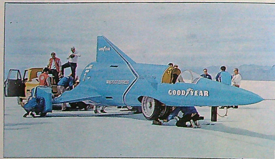
T v: Servicepersonalen lägger sista handen vid "Wingfoot Express" före en av provkörningarna. Det krävs en jättestab av tekniker för att hålla bilen i trim. Mitten: Utformningen av "Wingfoot Express" har dikterats helt med hänsyn till aerodynamiska faktorer. Bilen betraktas som ett skolexempel på fulländad design
