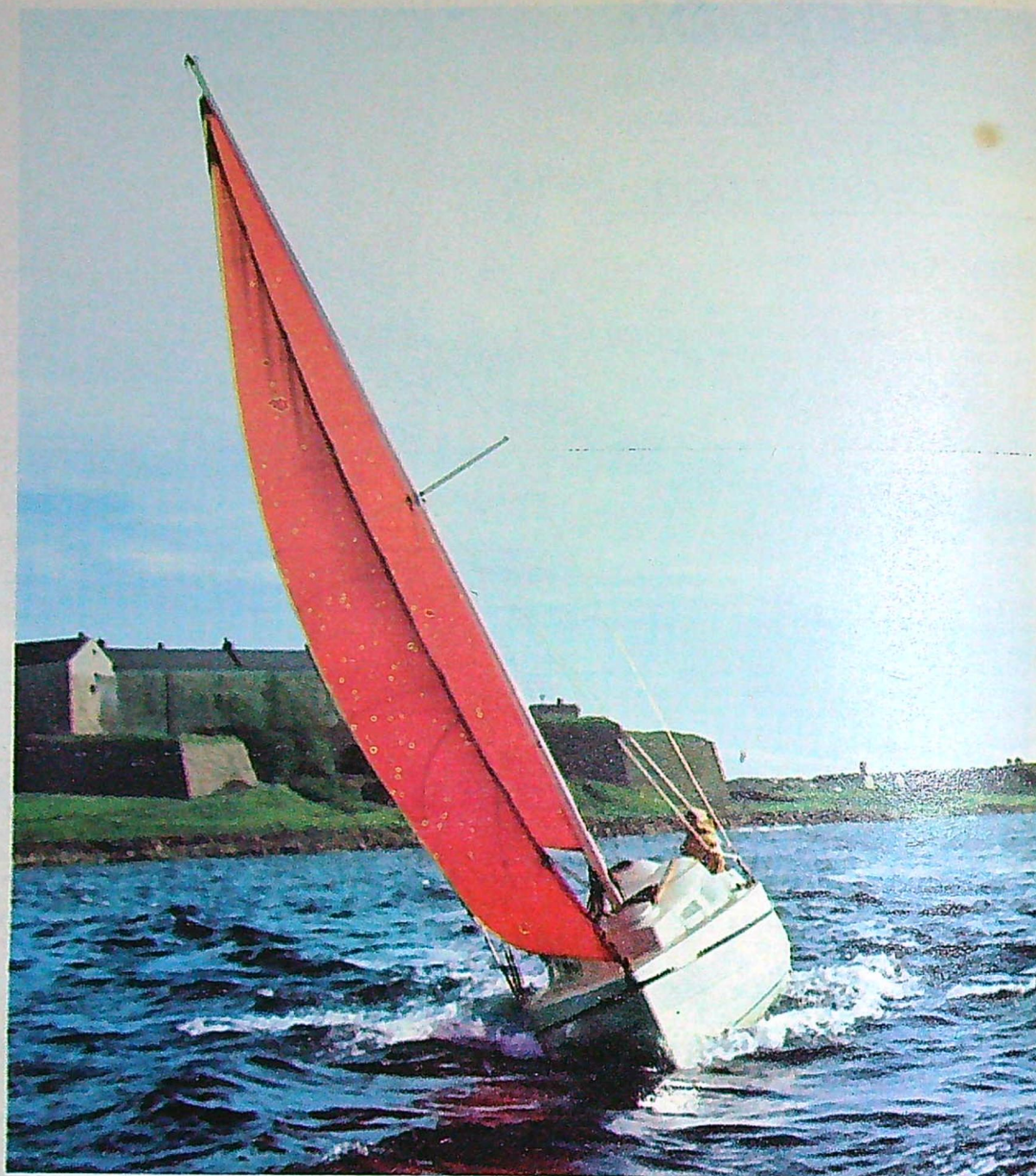
Monarks nya Varianty är en ruffad JOG-kryssare i glasfiberarmerad plast. Båten är närmast att betrakta som en ruffad version av Avanti, därav namnet.
