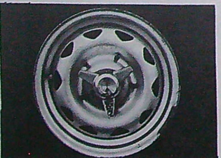
Den stora knackmuttern är det enda som håller hjulet. När man ska byta hjul är det bara att lossa muttern med en kopparklubba.
