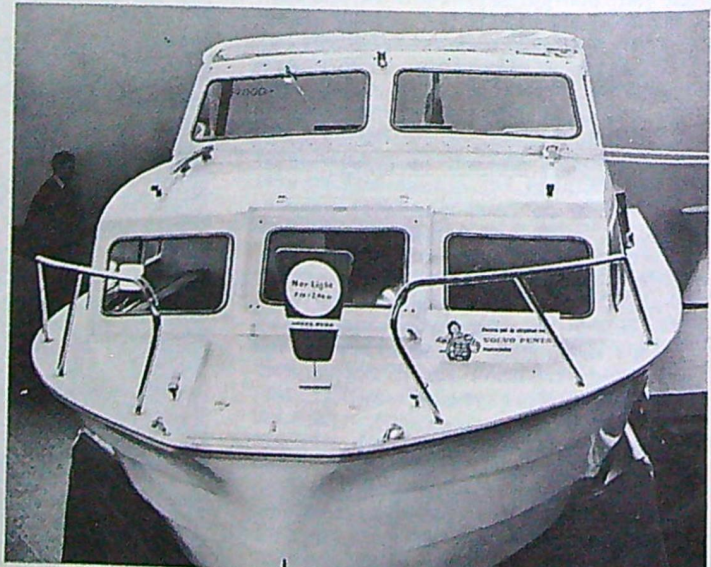
AB Gösta Berg visade bl a en ny, elegant norskbyggd kabinbåt i glasfiberarmerad plast. Norlight är 7,8 m lång och 2,9 m bred, har djup V-botten och dubbla förkabiner med totalt sex sovplatser. Kostar 49 000:— med Aquamatic-drev.
