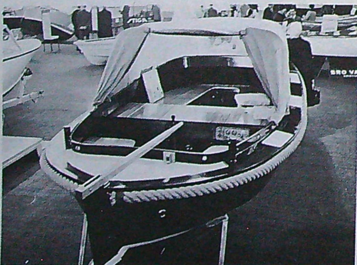
Detta är något så ovanligt som en snipa i lättmetall. Den tillverkas av Metallverken, mäter 5,80x2,10 m och gör ca 6,5 knop med en 10 hk Albin inombordsmotor. Båten är byggd av helsvetsad aluminiumplåt och kostar 11 900:—.
