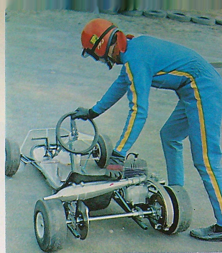
På bilden framgår tydligt detaljerna kring motor och bakaxel. Lägga märke till motor-fästet som är justerbart för att passa de flesta motortyper. På bilden nedan TFA-Kart Mk II under den allra första provturen på OSWE-ring strax utanför Stockholm.
