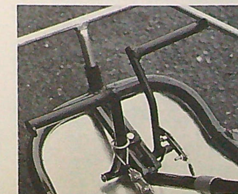
Pedalstället är justerbart inom vida gränser, vilket gör vagnen användbar även för småväxta förare i klass E och A pop, där åldersgränsen är 12 resp 14 år.
