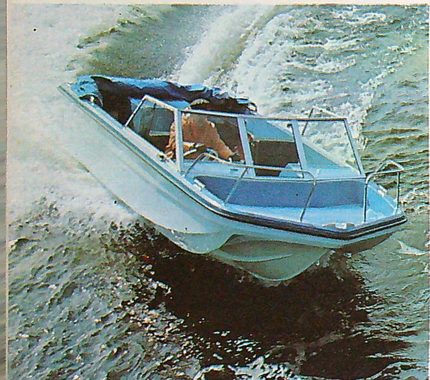
Trifoil 120 är snabb, stabil och förvånansvärt rymlig. Tack vare den öppningsbara mitttrutan har man kunnat krympa ner skarndäcken till minimala mått. Sittrummet är 1,95 m brett, inte dåligt med en båtbredd på 2,12 m.
