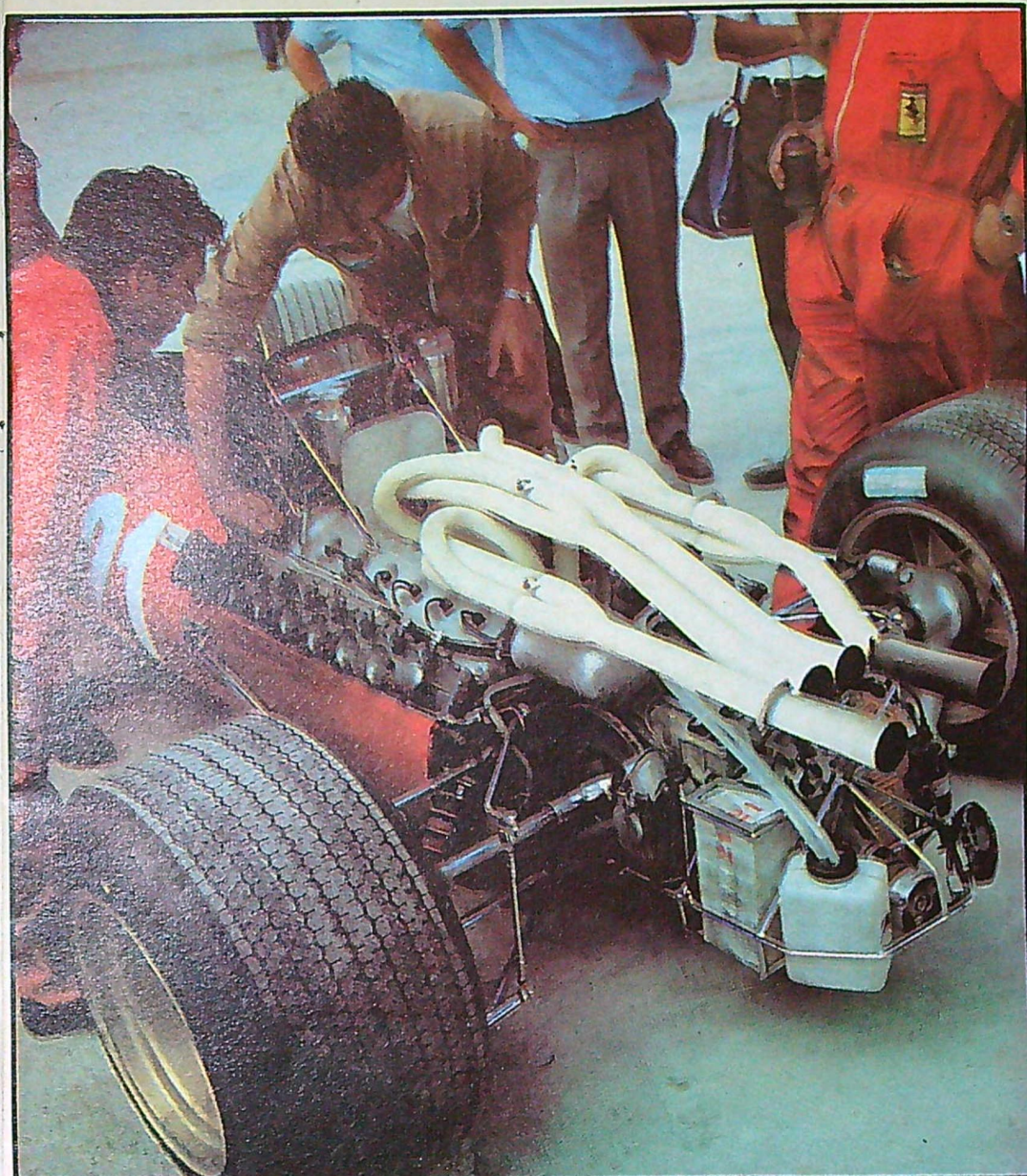
Fords V8 är tillsammans med Repco-motorn som Brabham använder undantagen från regeln som säger att det ska vara en V12 i år. Motorn på bilden sitter i en McLaren, men också Matra och Lotus använder Ford-motorn. Till höger Ferraris senaste motor, som om man får tro ryktena från fabriken är god för några hästar mer än i fjol. Ferrari är den enda motor som har avgasrören liggande ovanpå motorn och är därför mycket lätt att känna igen.
