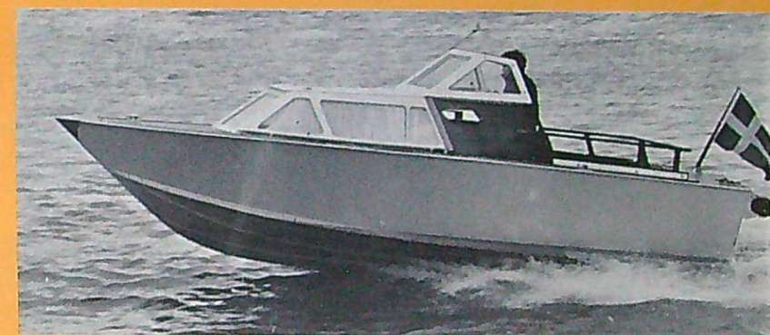
Bilderna visar att det ibland går att uppnå en betydande förbättring av en båts gångläge om man forser den med trimplan. På bilden överst plöjer båten fram med aktern djupt ner i sjön. Nedan har den försetts med Novil-trimplan och intar en korrekt trimläge. Till detta bör nämnas att en båt inte bör bete sig som på bilden ovan — en så aktertung båt får betraktas som antingen direkt felkonstruerad eller utrustad med olämplig motor.
