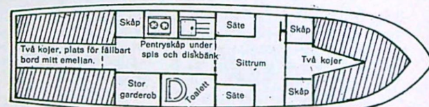
Mary Belle var strikt formgiven efter slussarna. De raka friborden är en fördel i slussarna, liksom frånvaron av utskjutande utrustningsdetaljer.
