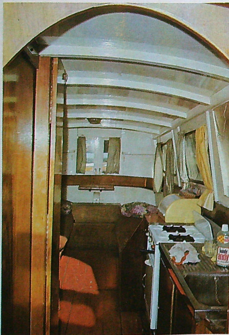
Det var full ståhöjd i aktersalongen. Närmast pentryt med rostfri diskbänk och tvålagigt gasolkök. Med hjälp av en viddörr kan pentryt avskäras från aktersalongen. Akterfönstret är öppningsbart, däremot inte sidofönstren.
