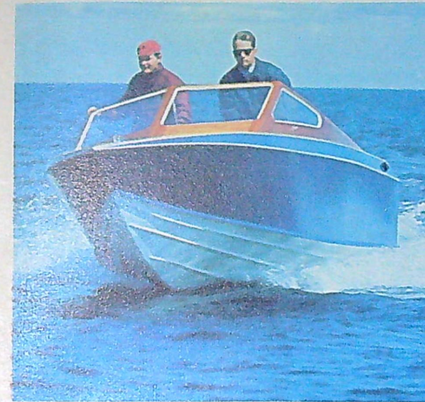
TFAs Kabinbåt — bilden th — är lättplanande och ittdriven. Den är också ett utmärkt exempel på ett det går att få fram mycket eleganta former även med ett skivmaterial som plywood.
