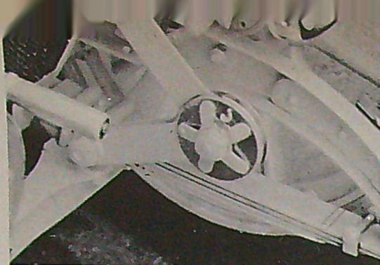
T v: Friktionsstöt-dämpare av Hartford-typ finns på Mercern. T h: i förgrunden tanken, ratten med reglage för gas och tändning, till höger om ratten växelspaken och handbroms.
