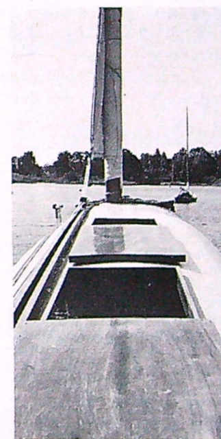
"Däcket", som samtidigt är överbyggnadens tak, är inte direkt avsett att valsa på. Lagg märke till den långsgående skenan där storseglets skotpunkt förskjuts automatiskt då seglet rullas på eller av masten.
