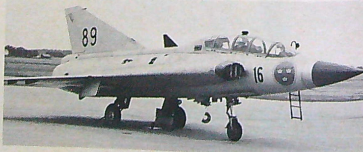
Längst till vänster den föga framgångsrika "skolfalken", Sk 8 kallad, tillverkad 1929 av Svenska Aero AB på Lidingö. Här ovan visas Saabs tvåsitsiga skolversion av framgångsrika Draken. Den här varianten kallas Sk 35C och har nästan lika fina prestanda som 35B. Överst det kommande överljudsskolplanet SK 37, en tvåsitsig utgåva av redan nu världskända Viggen. Detta plan provflygs just nu och leveranser påbörjas om några månader.
