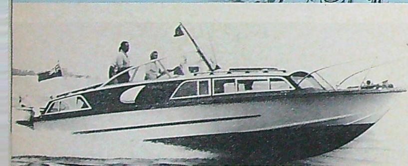
Fairey Huntman 31 är en helt ny kabinbåt i Faireys offshoreserie. Skrovet är utfört i formpressad plywood och denna 9,5 m långa båt gör 27 knop med två 145 hästars Perkins-dieslar.
