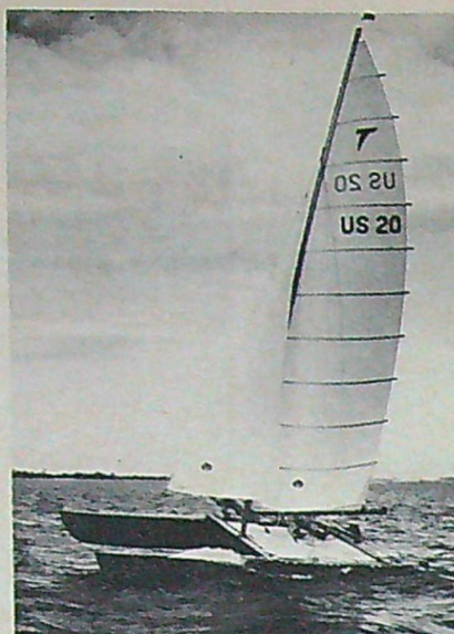
Tornado är en ny snabb segelkatamaran. Den är konstruerad av Rodney March, mäter 6,00 m x 3,00 m, är byggd av plywood och som en kuriositet kan nämnas att borden i pontonerna inte är skruvade utan fastsydda med koppartråd.
