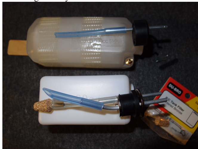
Tank-tips_Sintrad klunk till Q500-tanken gör underverk. Den övre Tetra-ballongtanken till SQ behöver ingen klunk. Och trycket från ljuddämparen ligger mellan tank och ballong
