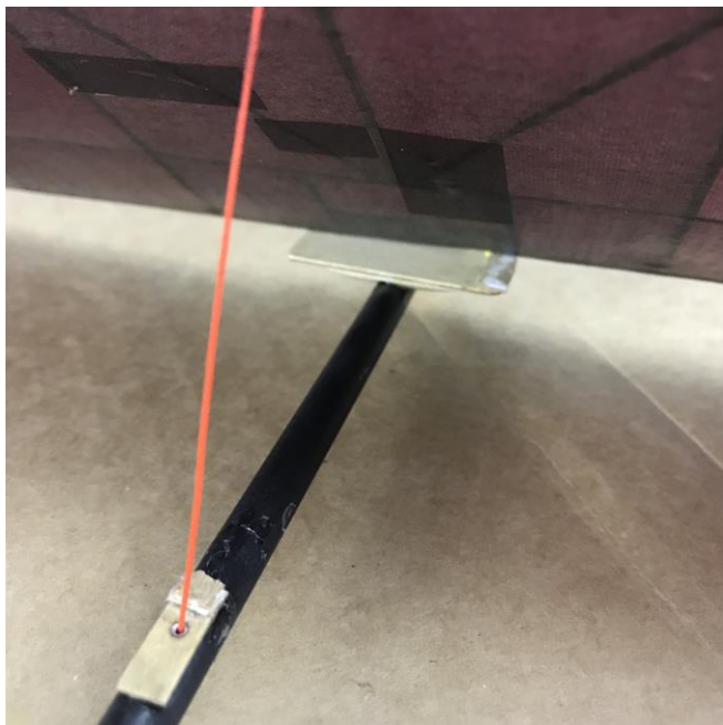
Här ser man tydligt pallningen på stabbryggans högra sida, det ger lite sväng åt höger. Och på det bakre fästet ser man att jag limmat tunna plywoodbitar för att ge en högre höjd för bakkanten sett mot kroppens centrumlinje.
