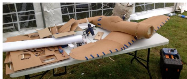
Med lite teknik kan man tydligen bygga cylindriska kroppar med platta skumskivor.
