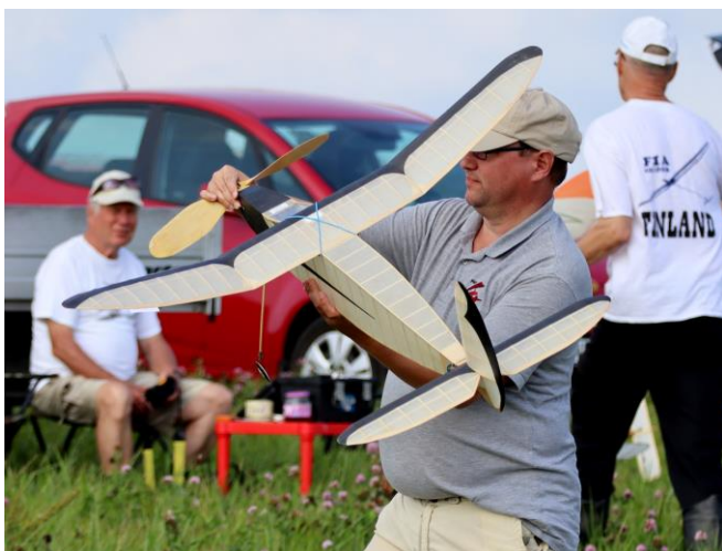
En rejäl gummimotormodell. Gummimotorn väger ungefär lika mycket som resten av planet. Planet har vertikalprestanda!
