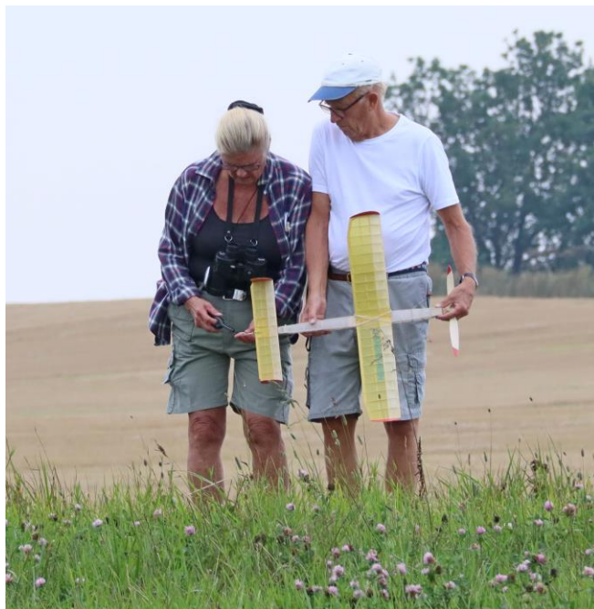
En gummimotormodell i näst minsta klassen som flögs på torsdageftermiddagen. "Timern" består av en långsambrinnande stubintråd som bränner av en tråd som ställer höjdrodret uppåt så att planet dalar ner efter önskad flygtid. Karin tänder på Richardf Borglunds Fuse
