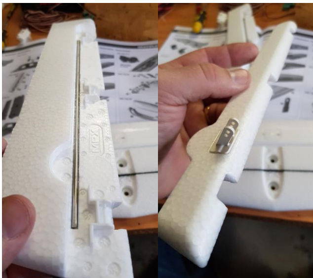
Tunna aluminiumrör styrar upp där kolfiber kanske är för tungt. Varje gram räknas 😊
