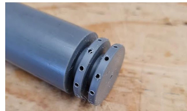
Navämnen: enklast att borra de 12 hålen på vardera skovelhjulsnavet innan naven sticks av i svarven. Materialet jag valt är grå PVC (skittråkigt material att maskinbearbeta)
