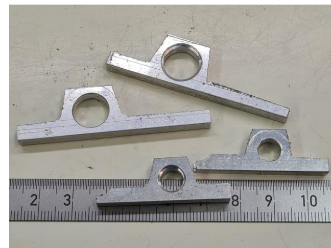
Utsågade. Nu skall de filas. Sedan skall små hål för att fästa dessa i själva däck.
