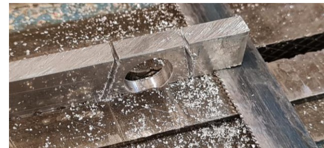
Lagerbock: visst kam man fräsa dessa så det blir jättefint, men såga o fila går fortare i alla fall om man inte har "extra lättgående militärfilar". Hålen för flänskullagren borrarade jag först innan jag sågade isär bitarna.
