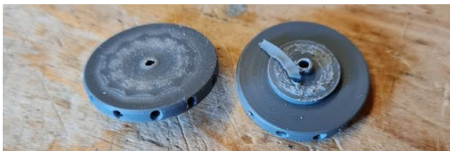
De borrarade och avstuckna skovelhjulsgavelnaven.
