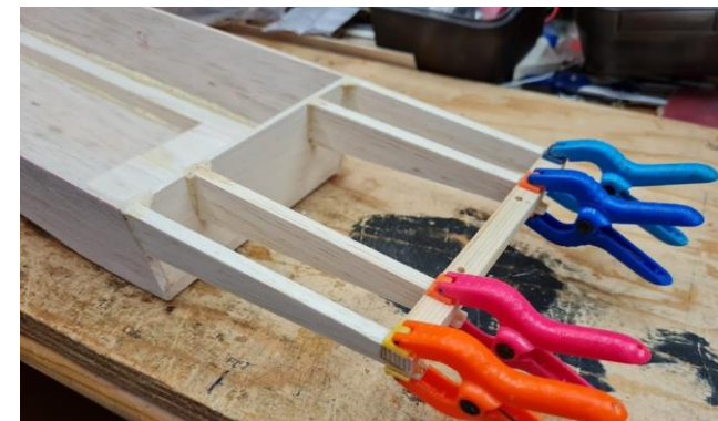
Skrov_oderbalk: Furu är nog bra för att hålla mässingrören med de två roderskåddorna. Här har även hjulupphängningen limmats mot akterspeglin.
