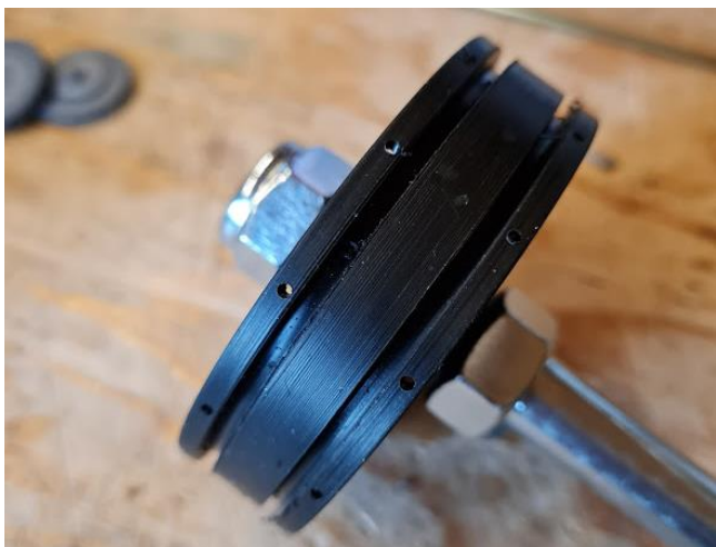
Ett passande dimensionsmässigt billigt nylonhjul svarvades till och det blev en "fälg" på vardera sidan av hjulet. De 12 hålen är borrarade innan det sista momentet att sticka av dem från hjulstommen.
