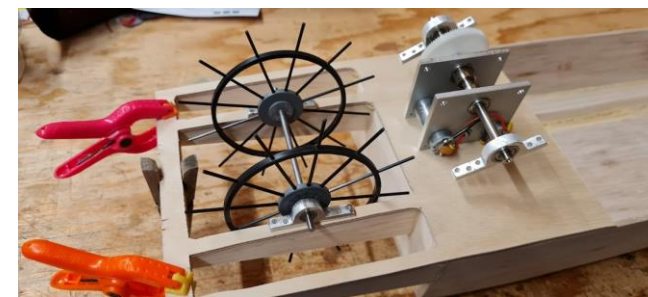
Här har en plyfabit sågats till. Plyfan skall senare ersättas av mahognydäcket.
