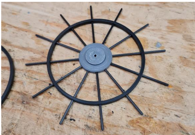
Provmonterad gavel. Den yttre "fälgen" är från ett nylonhjul som hade passande mått. 1,5 mm kolfiberpinnar
