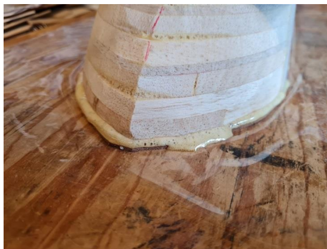
Däcket limmas med PU-lim som skummar en del, ja det ser skumt ut...
