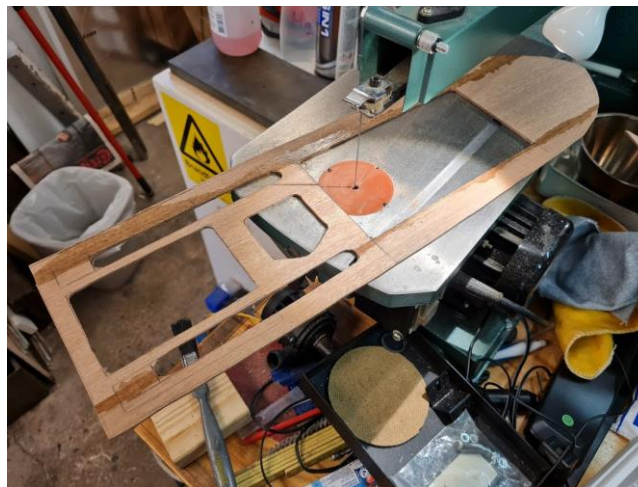
Mahognydäcket 2 mm tjockt sågas till
