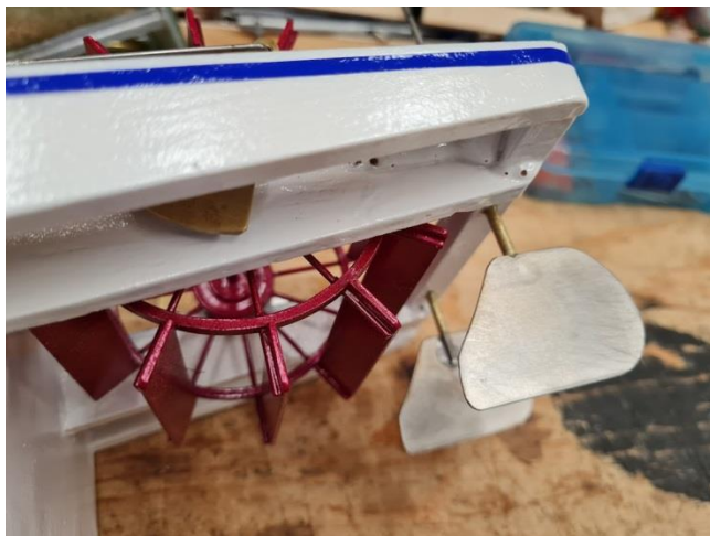
Rodren monterade med sina 2 mm diam. Rostfria axlar i sina mässingrör
