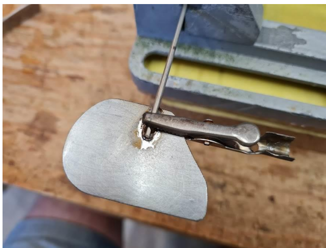
Roderskåddorna är av 0,7 mm rostfri plåt som lödats på en lätt nedfilad axel. Här har jag använt amerikansk lödtenn som biter på rostfritt. StayBrite. 96% tenn och resten silver. Extremt mycket starkare än ”radiolödtenn 60/40”. 3F-hobby tar hem detta på beställning.
