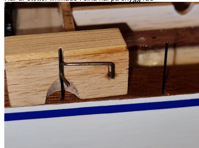
En enkel fixtur som dels håller kolfibret i perfekt vinkel, men även ger reproducerbar höjd. Fixturen är av rödbok och påbyggd med furu för att ge 17 mm höjd. Furubiten togs bort för stöttorna på övre däck som är litet kortare.
