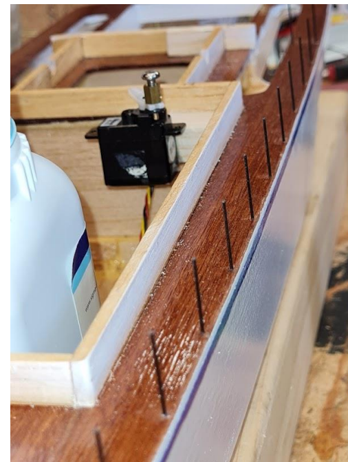
Här är stöttor limmade i sina hål på snygg rad
