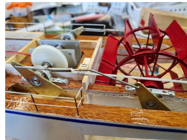
Monterat och intrimmat med ekorrhjulet lägre och stöstångerna bockade. Medge att lödhylsjustering är smidigt!
