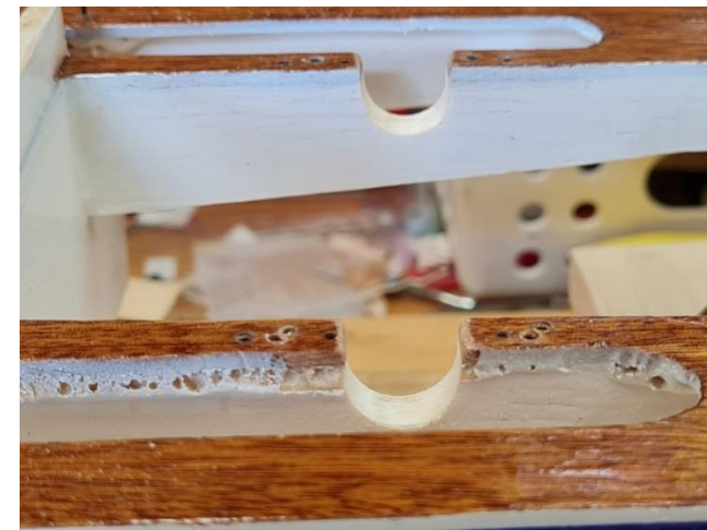
Bakre lagerbockarna måste vändas – här syns urtagningen för den babordriga och den styrbordriga skyrtar i bakgrunden
