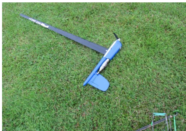
Per Stjärnesunds vinnande modell i F2A Speed. Vinge av kolfiber, enbladig kolfiberpropeller och en kropp med så lite luftmotstånd som möjligt. Motorn, som är på 2,5 cc, är försedd med pipa för största möjliga effektuttag.
