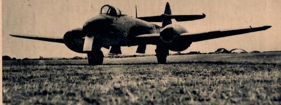
Det brittiska tvåmotoriga reaktionsjaktplanet Gloster »Meteor» var den stora sensationen vid RAF:s strålande uppvisning på Kastrup inför 250.000 köpenhamnare och andra flygintresserade. FLYG presenterar här ovan en bild av »Meteor», som har följande mått: spännvidd 13.71 m, längd 12.50 m, höjd 3.96 m, vingyta 34,74 m 2 . Bevärningen består av 4 st 20 mm akan i nosen. — T v en division Hawker »Tempest» (närmast) och en division Supermarine »Spitfire».
