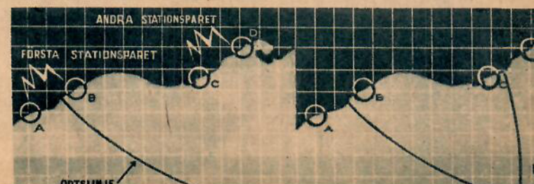
Ovan: Typisk bild av flygplanmål på avståndsrör tillhörande markradarstation (fasta ekon på 44—47 km och flygplanekon på 48 och 59 km, övre skalan gäller). — Nedan: Loras princip. Ortslinjen för en viss gångtidsskillnad för radiovågen utgörs av en hyperbel. Måtes gångtidsskillnaden till ett andra stationsspar fås en ny hyperbel och i skärningspunkten mellan hyperblarna befinner sig flygplanet.
