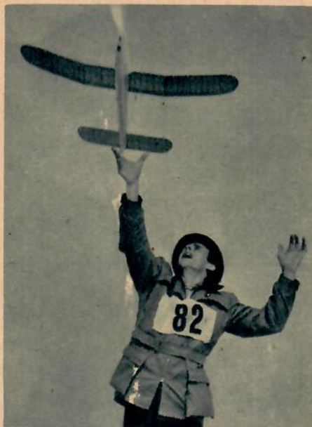
Bo Boberg med sin segrande F-modell. En lyckad konstruktion med motorkåpa och timer som största finesser. Motorn är en »Västerås-diesels».
