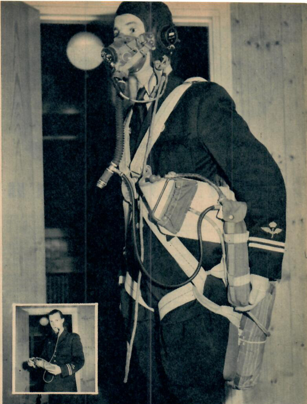
Ovan t. h.: Den nya utrustningen för fallskärmsbrott på hög höjd som skall införas på F 13 består av en normal Irwing-skärm med centralås men är försedd med en liten syrebehållare som sitter i ett fodral på vänstra sidan. För att få apparaten i gång behöver man bara dra i utlösningshandtaget ovanför fallskärmsutlösningen. Syrgasen räcker för 10 min. Bakom den invecklade attiraljen döljer sig löjtn. C. F. SCHNELL. — Införd: Den gamla syrgasutrustningen för fallskärmsbrott. — Nedan t. v.: Trafikledningen kan på några ögonblick förflytta sig från kontrolltornet t. ex. ner till skyddsrummet genom att som brandsoldater åka ner för denna stång. Här är furir LARS GREDIN på väg till kanslihusets nedre regioner. — I mitten: Så här ser F 13:s UK-radloanläggning ut. Det är trafikledare OTTO JOHANSSON som håller i mikrofonen. — T. h.: Trafikledare AGNE PETTERSSON visar på lappen »Plané 4 m/sek.», och furir LARS GREDIN vidarebefordrar meddelandet till en J 28 som just är på väg att landa med hjälp av radar och UK-pejling.
