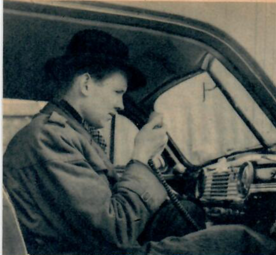
Bilradlostationen i tjänst — man lyfter mikrofonen från en hållare på instrumentbrädan, trycker på en knapp och talar.
