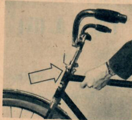
Framhjulsspärren har länge varit ett problem som nu lösts genom en enkel anordning i övre styrlagerskålen.
