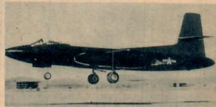
Curtiss XP-87, amerikanska flygvapnets nyaste längdstransjaktplan och det första plan i sitt slag som utrustats med fyra reaktionsmotorer. XP-87 är ett av de tyngsta jaktplan som någonsin byggts och dess vikt är endast obetydligt lägre än en Fortress-bombare. Planet är speciellt avsett för dåligtvädersflygning och är beräknat för en hastighet på ca 960 km/t. Det har en flygsträcka på 2.400 km och en topphöjd på ca 10.600 m.
