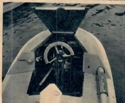
Den encylindriga motorn och styrinrättningen. Till höger syns kickstarten och under den »knäkopplingen». Till vänster sitter den ännu inte färdiga trycktanken.
