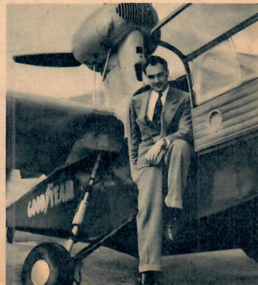
Ovan t. v. kabinen och t. h. det trevliga och lättflugna planet »Goodyear GA-2 Duck» av vilket firman byggt 15 exemplar. Dessa provas nu på olika platser i världen och först när resultaten av proven är klara beslutar man om serietillverkning skall igångsättas. — T. h.: Colonel Goodson vid landstället vars hela mekanism sitter i navet.
