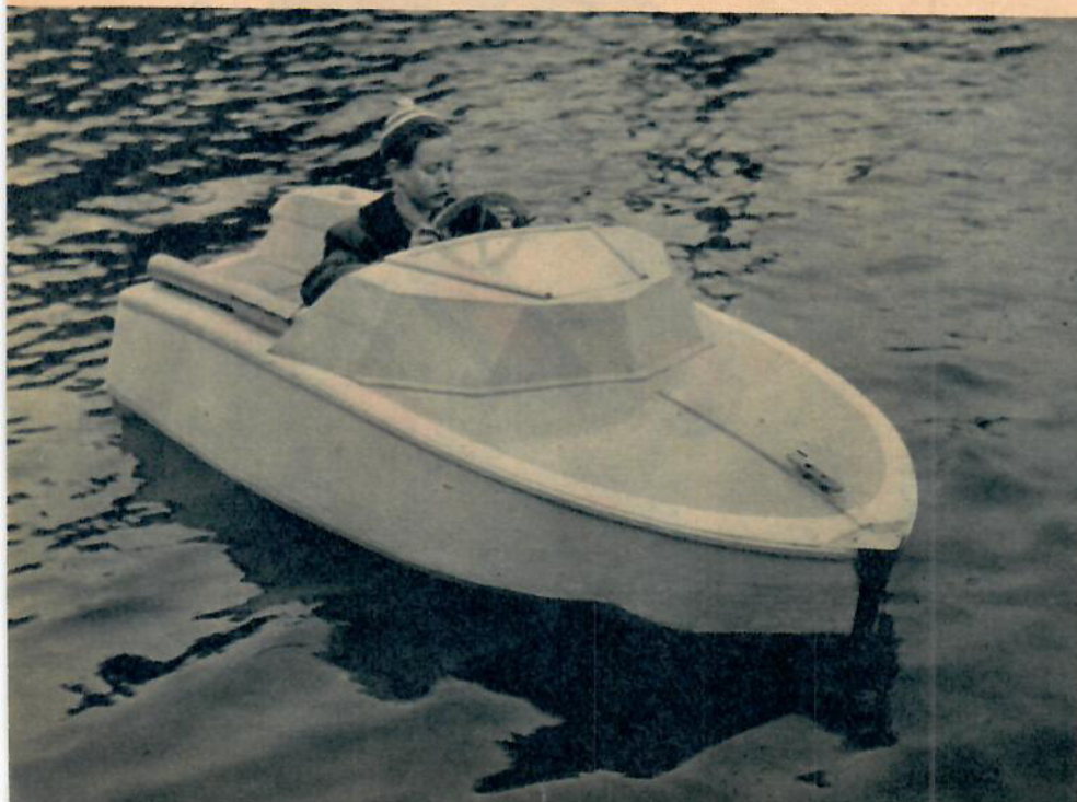
På bilden nedan är både Göran och hans båt i sitt rätta element. Båten är vit med blåa kanter. Under överbyggnaden döljer sig motorinstallationen. Den aktersnurrlänkande påbyggnaden är bränsletanken.
