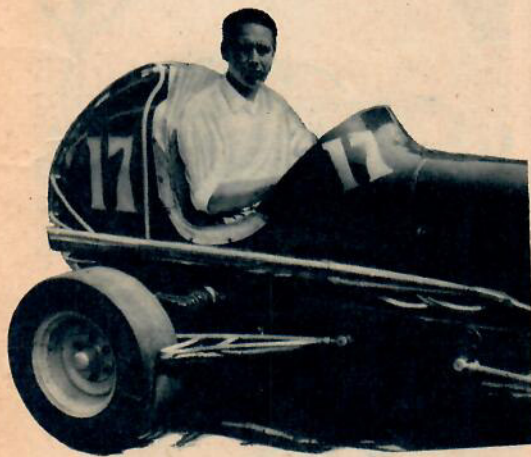
Artikelförfattaren, ordföranden i Svenska Midget-Racer Klubben, OLLE BERGSTRÖM, i en Ford V-8-midget. De breda bak hjulen med släta slitbanor är specialtillverkade för körning på asfaltbanor.
