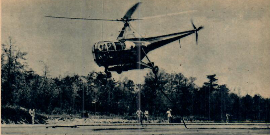
Helikoptern har blivit ett viktigt instrument i jakten efter nya olje- och mineralfyndigheter. Här ses en specialbyggd Sikorskyhelikopter med vilken man kan lägga rörledningar även i de mest svårforcerade terrängförhållanden.
