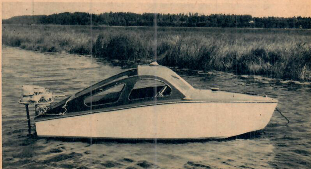
Båten har en Johnsson-stormbåtsmotor på 22 hk. Vid regn kan man spänna en sufflett över hela kabinen.
