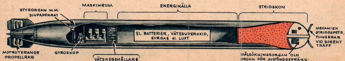
Röntgenteckning av en svensk 53 cm torped.
