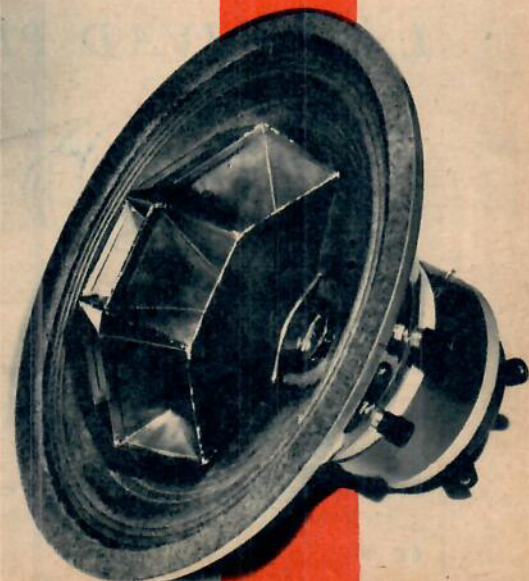
Ovan: Den största högtalaren i standardserien för belastning på 20 watt (den minsta är på 0,5 watt). — Nedan: Kombifonhögtalaren, som har skilda membran för höga och låga frekvenser varför alla toner återges med stor naturtrogenhet, en uppfinning patenterad av Svenska Högtalarfabriken. Genom ett filter fördelas de höga och låga frekvenserna mellan de två olika membranerna. Effekten är 10 watt, vilket räcker exempelvis för biografier.
