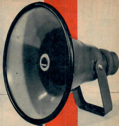
Ovan: Svenska Högtalarfabrikens krafthögtalare, kallat reflexhorn, eftersom ljudet får reflekteras tillbaka inuti det lilla hornet och sedan fortsätta att utbreda sig genom det stora. Till skillnad från standardhögtalaren utgör inte själva tratten här någon membran — vilket papperstratten fungerar som i förra fallet — utan denna utgöres av en liten fjäderlätt kalott som svänger inuti magnetsystemet.
