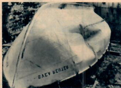
Den skadade livbåten till m/s »Svea Reuter» sedan bucklorna provisoriskt utstötts med trästöttor — Icke en läcka kunde upptäckas!
