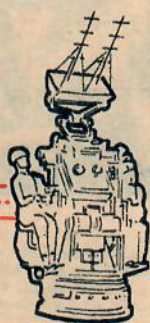
RIKTSTATIV MED RADAR OCH ELDLED- NING FÖR FJÄRRIKTNING AV EN ELLER FLERA 40 mm LVPJÄSER
