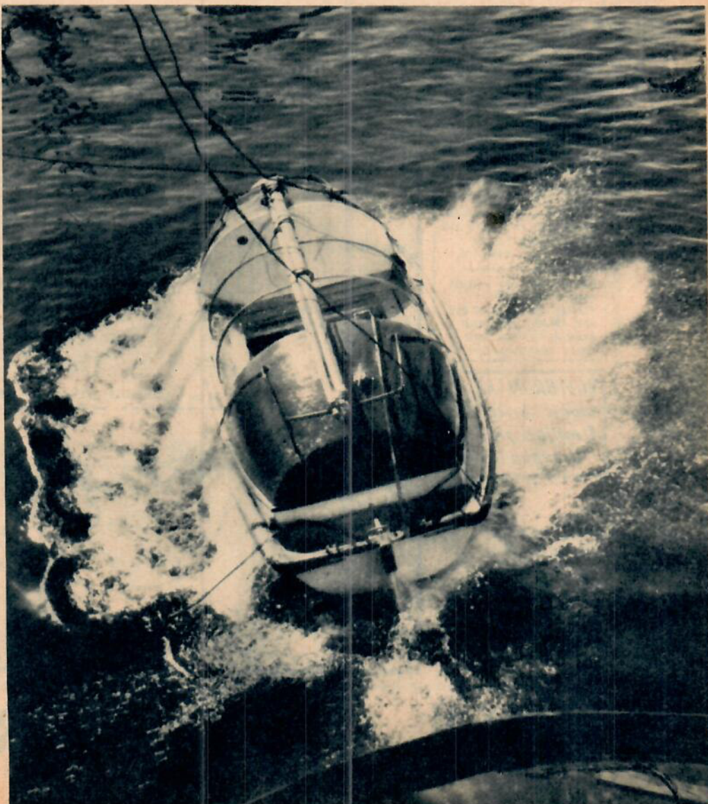
Den skadade livbåten till m/s »Svea Reuter» sedan bucklorna provisoriskt utstötts med trästöttor — Icke en läcka kunde upptäckas!
