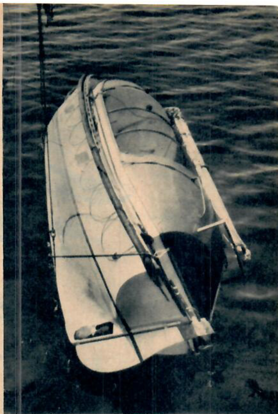
Ovan och nedan: Båten har inte mer än sänkts i vattnet förrän de självläsnande krafterna slänger båten på rätt köl.
