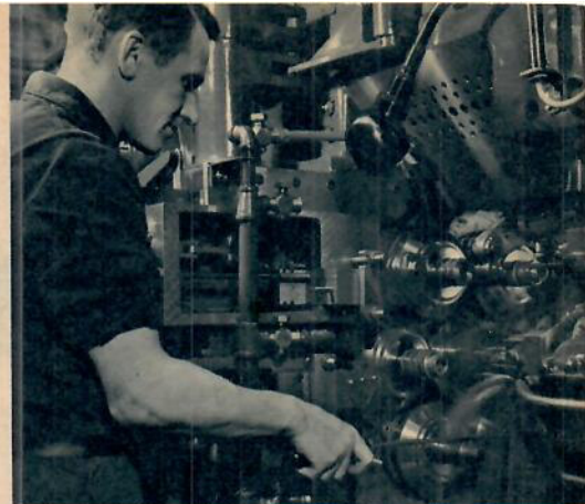
Kullagerstålet framställs vid Hofors Bruk och levereras till SKF i form av rör, som utgör utgångsmaterialet för medelstora kullagerlringar. Av rören svaras sedan ytter- och inreringar. Detta sker ovan i en 6-spindlig automatsvarv.
