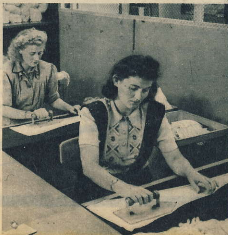
Nedan t. v.: Strumpskäften synas med genomskinliga »strykjärn» av plast. — Nedan t. h.: Kontroll av råstrumpan som utsätts för samma töjning som i verkligheten.
