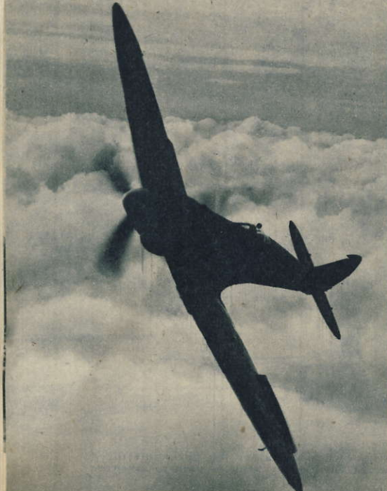
Spitfire Mk 14 (bilden) har fått lämna flygkroppen till Mk 19 — flygplanets nya fotospanings-Spitfire —, medan vingarna är en modifiering av Mk V:s.
