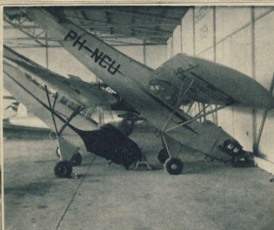
Så här på nosen stuvats Cubsvärmarna in i hangaren på Ypenburgsfältet, med propellern i en bädd. Detta arrangemang sparar mycket plats.
