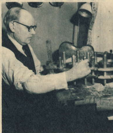
Violinbyggare A. Ronnell, Stockholm, är 72 år och har arbetat i facket i 50 år. Han anses som en av vårt lands främsta på området. Övan t. v. sätter han in en ny basbjälke i en gammal fiol. — Övan t. h. sätts en fiol i tvingar för hopplimning och nedan t. v. säger Ronnell ut ett fiollock.
