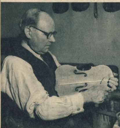
Violinbyggare A. Ronnell, Stockholm, är 72 år och har arbetat i facket i 50 år. Han anses som en av vårt lands främsta på området. Övan t. v. sätter han in en ny basbjälke i en gammal fiol. — Övan t. h. sätts en fiol i tvingar för hopplimning och nedan t. v. säger Ronnell ut ett fiollock.
