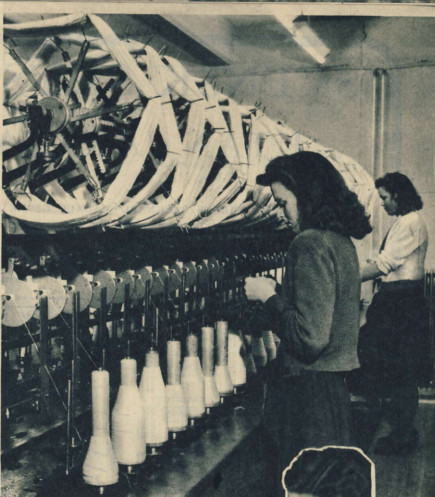
Ovan: Här omspolas garnet och överförs på stickmaskinernas specialspolar.
