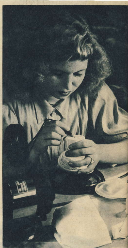
Ovan: Uppmaskning med tryckluftsdriven uppmaskningsmaskin. — Nedan: Efter färgningen pressas och formas strumporna innan de kommer till sista kontrollen och förpackningen.
