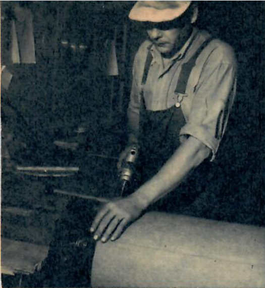
Nitningen utförs med hjälp av elektriska borrar.
