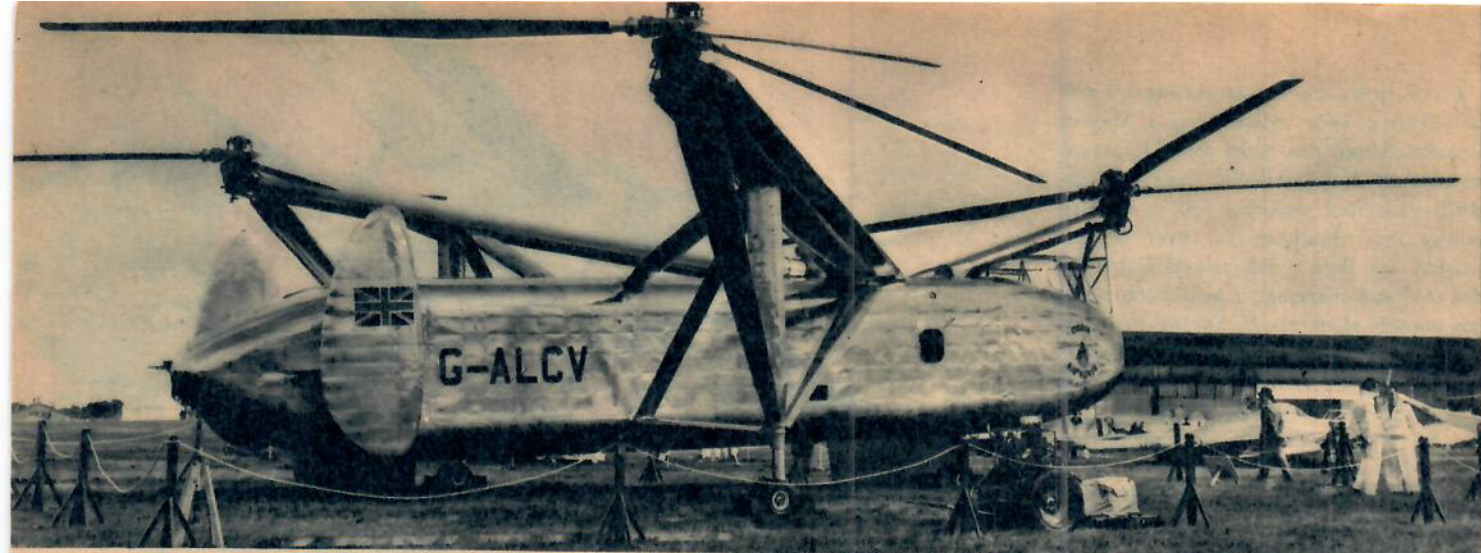
Världens största helikopter, den trerotoriga WII »Air Horse», kan ta 24 passagerare eller mellan 3 och 4 ton last. Rotorerna är närmare 15 meter i diameter.
