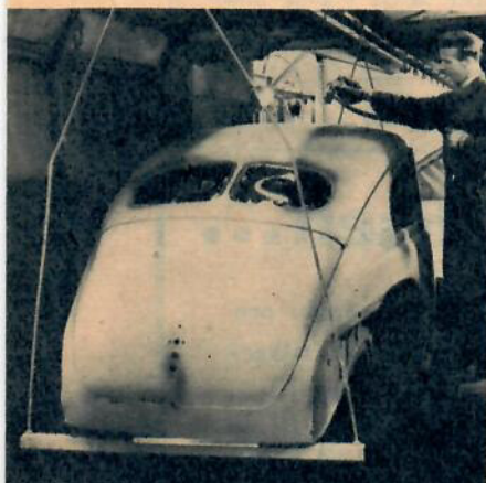
Färgen sprutas med tryckluft. T. v. ses »vattengardinen» — vatten som rinner utmed en plåtvägg.
