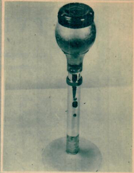
En elektrodynamisk mikrofon som bl. a. används av Radiotjänst. Känslighet med transformator -48 dB. Priset är 180 kr.
