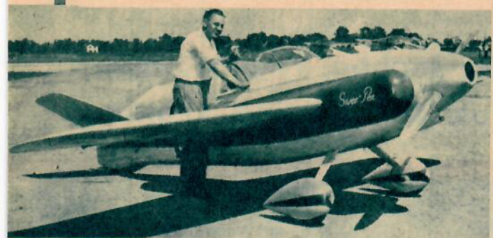
Goodyear-trean Art Chesters racer »Sweet Pea» har V-formad stabbe och saknar fena-sidroder, vilket arrangemang modellplanbyggarna brukar kalla »stabiliffena». Det verkar som om kylluften tus in genom det stora hålet i spinnern.
