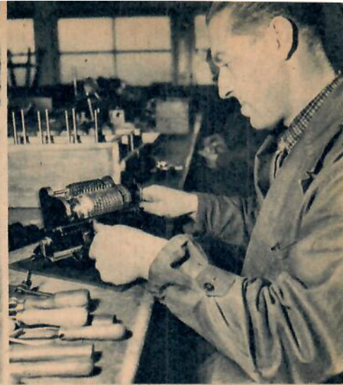
Mellan varje operation genomgår maskinerna en noggrann kontroll och här granskar ARVID ERIKSSON en »räknesnurra».
