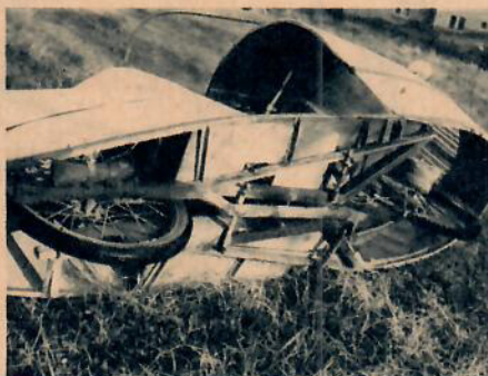
Scootern sedd underifrån. Materialet till ramen är lätta, starka flygplansrör.
