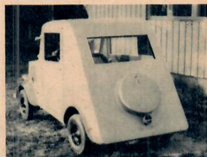
Karossen är byggd i trä och masonit. Reservhjulet har ett prydligt fack baktill.
