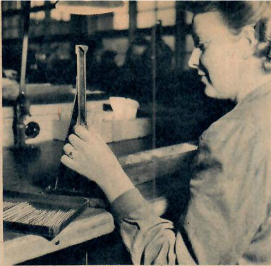
Här kontrollväger fru ASTRID EKLÖV spiral-fjädrar som används i stor utsträckning på räknemaskinerna.
