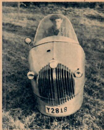
Tre strålkastare av cykeltyp med 6 volts spänning lyser upp i mörkret.
