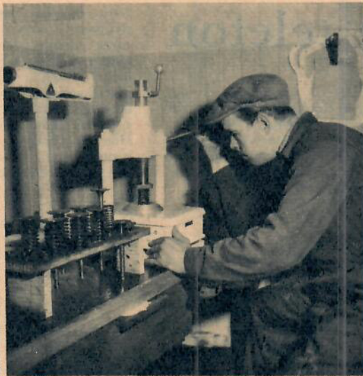
Kontrollen är lute minst viktig och bolaget har en fullständig uppsättning av kontroll- och mätverktyg. Här kontrolleras att ventilljädrarna har rätt spänning.
