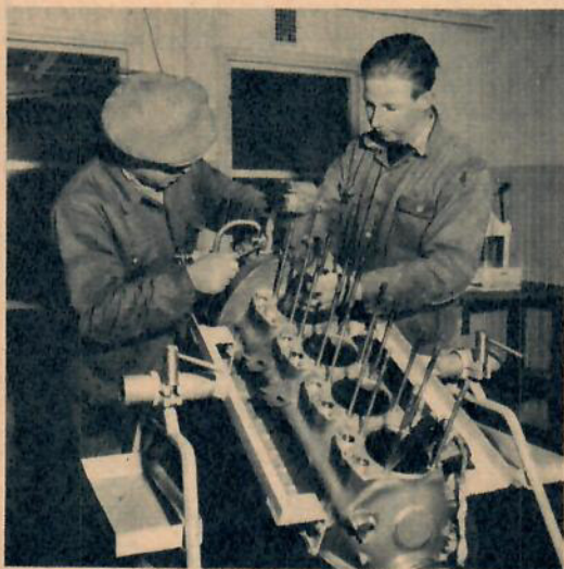
Reparation av Gipsymotor
