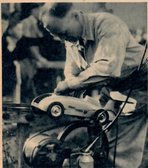
Någonting för »Getingarna» och andra svenska modellracerentusiaster är denna startapparat som drivs av en elmotor vars varvtal hålls konstant av en luftkompressor.
