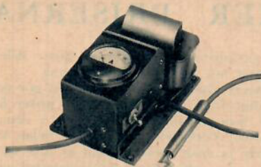
Ankarprovare för generatorer. För att mäta om det är avbrott eller kortslutning någonstans i ankarlindningen tar man provplinnen och berör olika delar av lindningen. Av den härav erhållna spänningen, som avläses på anslutningsmätet, kan man uppskatta om det finns ett fel. Priset för ankarprovaren är omkring 110 kronor och den användes företrädesvis av bilverkstäder.
