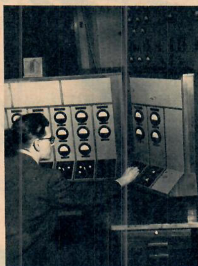
T. v.: Civillingenjör BJÖRN ASTRÖM — elektroteknisk expert vid atominstitutet — sitter framför manöverbordet i den stora cyklotronens kontrollrum vilket är skyddat från strålning bl. a. genom en två meter tjock vattenvägg. — T. h.: De 30 cm grova kopparrören som syns upptill på bilden utgör galler- och anodledningarna i 240 kW kortvägssändaren. — Nederst ligger vacuumtankarna till de två kvartsvägsledare som befördrar svängningarna till cyklotronen.
