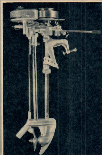
ELIOS 33: cylindervolym 33 cm 3 , varvtal 4.000 v/min, effekt 1,2 hk, bränsleförbrukning 0,5 l/tim. vikt 7 kg. Magnetändningen är av typ Marinelli-Bosch.
