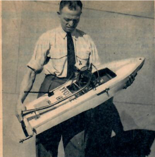
Modellbåtsracing är populärt i Australien. Denna båt är en meter lång och har gjort 75 km/t. Båten har byggts av J. DOUCE och motorn är en av Norman Coopers fyr-taktare.
