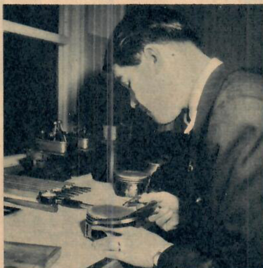
Kontroll av kolvdimension
