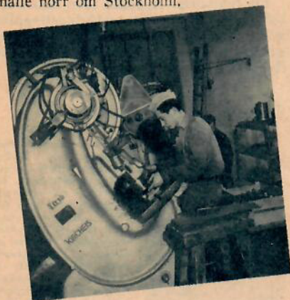
HELGE AUTERO pressar lock i en av de stora verkpressarna.
