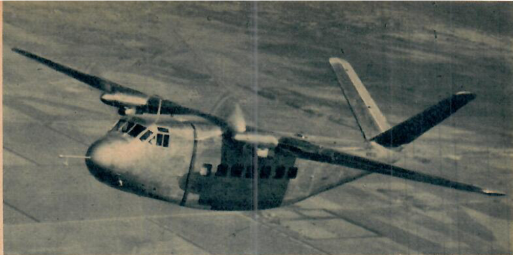
Beechcraft Twin-Quad som det nya flygplanet på bilden kallas har flera intressanta nyheter i konstruktionen. Planet har sålunda motorerna inbyggda i vingarna (ett system som lancerades på Bristol Brabazon) och de fyra motorerna är kombinerade så att de tillsammans driver två propellrar. Planet har vidare speciella förstärkningar i botten av flygkroppen, vilket minskar kraschrisken vid nödlandning, och är även konstruerat med s. k. stabilifena. Twin-Quad som tar 20 passagerare undergår f. n. flygprov i Wichita.
