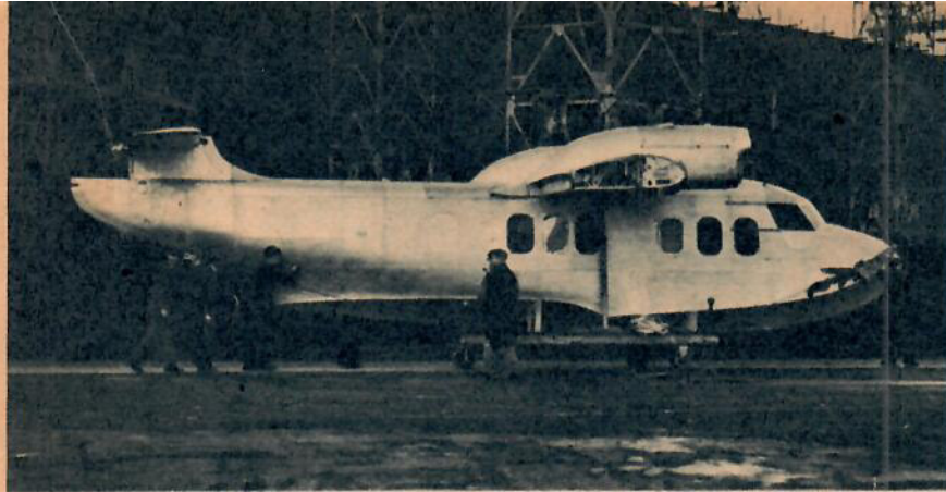
T. v.: På bilden ses kroppen med påmonterad mittvinge och motorerna till den första prototypen av Short Sealand under transport från Short Bros till Harland Ltd, vid Sydenham. — T. h.: Prototypen till Sealand under hopmontering.
