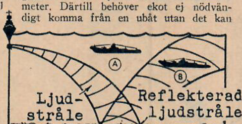
Ovan: Genom förekomsten av kalla och varma vattenskikt kan ljudstrålen brytas ned mot botten (t. v.). Ett relativt närbeläget föremål kommer därigenom inte att upptäckas, men däremot ett längre bort (t. h.). — Nedan: Äldre ljudsändare utsände ljudet i alla riktningar varvid det återvändande ekot blev svagt (t. v.). En modern sonar utsänder i stället en kraftig riktad stråle (t. h.).
