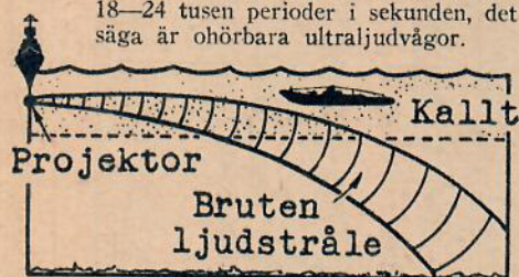
Ovan: Genom förekomsten av kalla och varma vattenskikt kan ljudstrålen brytas ned mot botten (t. v.). Ett relativt närbeläget föremål kommer därigenom inte att upptäckas, men däremot ett längre bort (t. h.). — Nedan: Äldre ljudsändare utsände ljudet i alla riktningar varvid det återvändande ekot blev svagt (t. v.). En modern sonar utsänder i stället en kraftig riktad stråle (t. h.).
