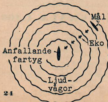
Ovan: Genom förekomsten av kalla och varma vattenskikt kan ljudstrålen brytas ned mot botten (t. v.). Ett relativt närbeläget föremål kommer därigenom inte att upptäckas, men däremot ett längre bort (t. h.). — Nedan: Äldre ljudsändare utsände ljudet i alla riktningar varvid det återvändande ekot blev svagt (t. v.). En modern sonar utsänder i stället en kraftig riktad stråle (t. h.).
