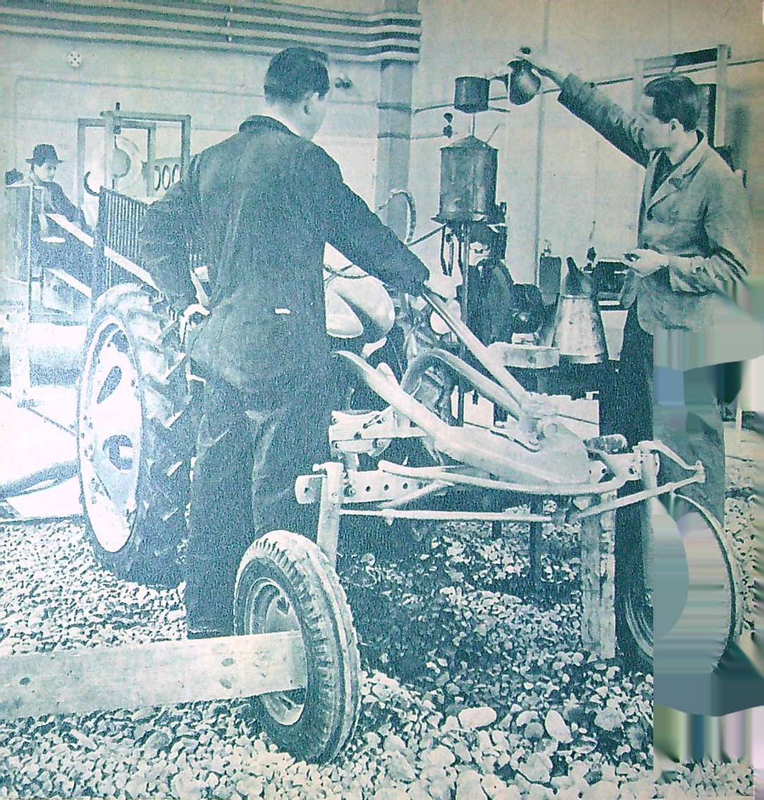
För att fastställa remskiveffekten bromsas traktorn med en elektrisk effektvåg. Här ses den nya Allis Chalmers under prov
