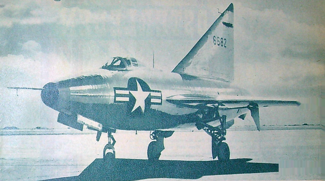
En färsk bild av amerikanska arméflygets nyaste fartvidunder. Consolidated-Vultee 3002. Vingen har formen av en triangel med en spetsvinkel av 60°. Höjd- och skevroden sitter i den raka
