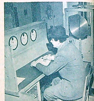
På elektriska mätare kan man avläsa motorns effekt och varv vid olika belastningar.
