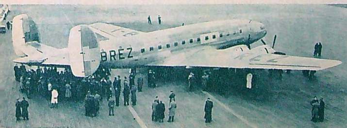
Ett av de största flygplan som byggts i Europa, det italienska trafikplanet Breda Zappata har nyligen provflygts. Planet har fyra motorer som driver var sin fembladiga propeller. Spännvidden är 62,1 m och längden 30,9 m. Flygglänt kan ta 50 passagerare och farten är 483 km/t.
