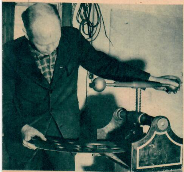
För tillverkning av vissa plåtdelar använder man en gammal bokpress. Här stansar Yngve Håkansson hål i en plåt till den bärande bryggan i bakvagnen.
