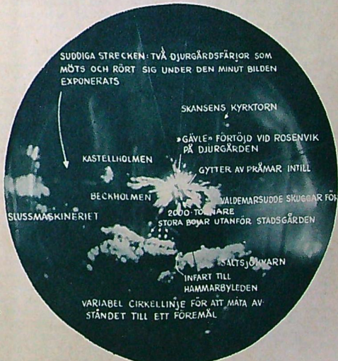
Här har radarskärmen fotograferats när fartyget ligger i hamn i Stockholm. Fotot är taget med en exponeringstid på en minut. Skalan på radarskärmen är sådan att radien utgör 1 sjömil.
