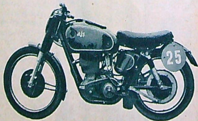
TT-maskinen har en dubbel vagnram med teleskopfjädrat bak-hjul och Teledraulisk framgaffel. Bensintanken rymmer 23 lit.
