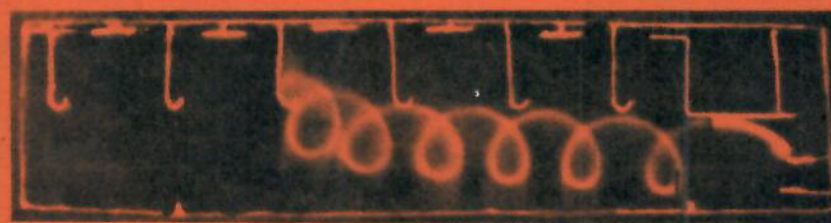
Omkoppling av trokoidstrålen från fack 1 till 3 genom ändring av tredje »spadens» spänning.
