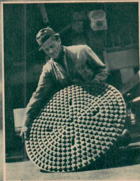
För att erhålla ett jämnt fördelat tryck mellan beläggning och belastningsplatta används en gummidubbsplatta vid laster upp till 45 ton.
