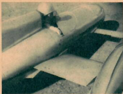
Den italienska rekordvagnen är försedd med en ställbar »vinge» som är placerad mellan gondolorna och har till uppgift att pressa vagnen mot vägbanan vid höga farter.
