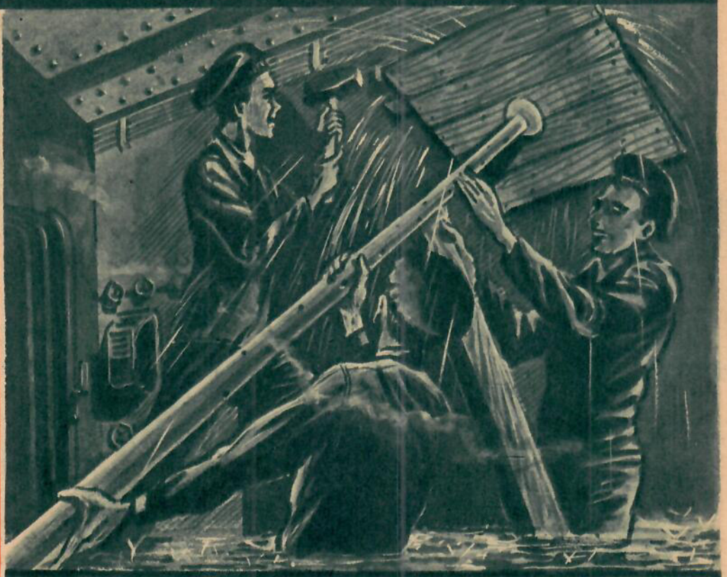
ANKARJÄRNSBULT OCH TÄTKUDDAR - ETT SNABBT OCH EFFEKTIVT PROVISORISKT TÄTNINGSMEDEL
