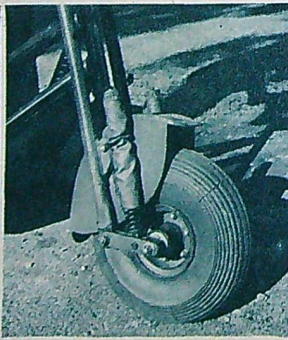
Framhjulsdningen ser ut att ha teleskopiska stötdämpare men är spiralfjädrar.
