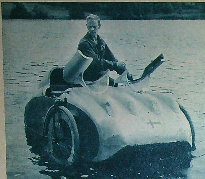
De hemmagjorda Åronna kom väl till pass när propellern gick sönder i flaska skärgården. Med två personer i amfibilen är dess djupgående endast omkring 11 cm.
