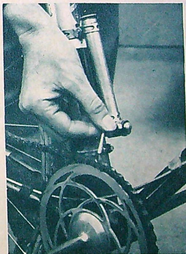
Denna lilla enkla oljepump håller kedjan vid god vigror under körning. Den sköts med foten.
