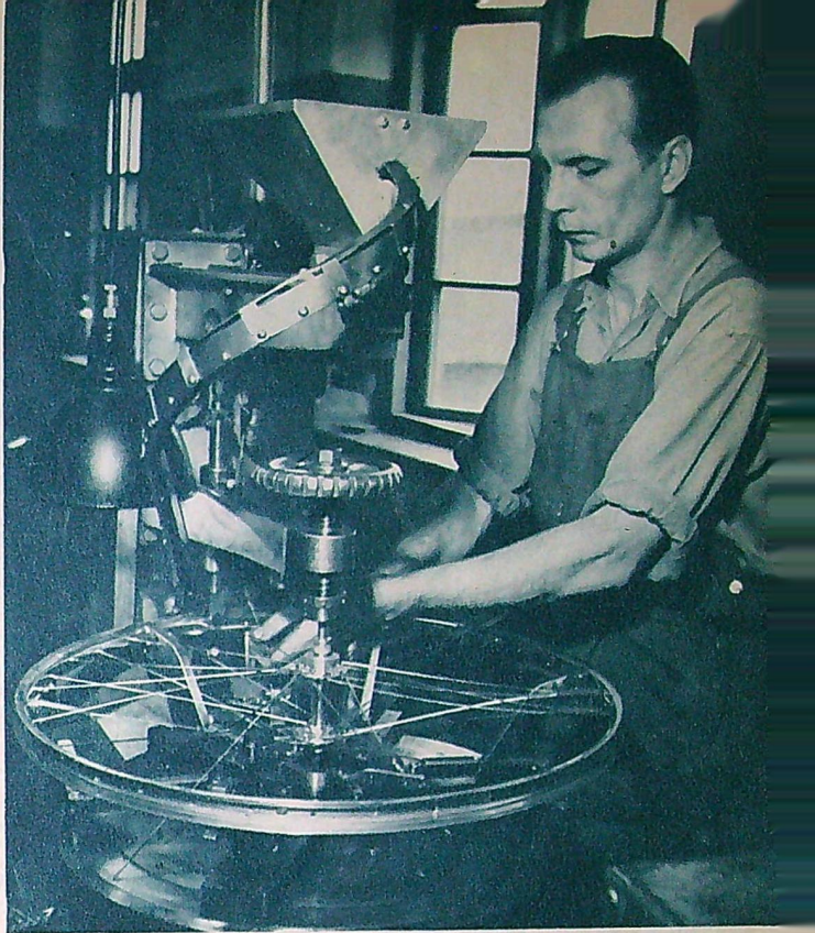
Nymanbolagen i Uppsala som bl. a. tillverkar Crescent, har konstruerat denna hjul-uppläggningsmaskin. Cirka 32 hjul per timme förses med ekrar av Martin Malmberg.
