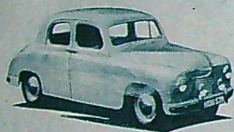
Beläglig åkning bjöds de sex personer, som ryms i nya Singer 1500, tack vare sätenas placering mellan axlarna, det rikliga utrymme inuti vagnen och den förmåliga fjäderingen. Stänkskärmmarna är lätta att ta av.
