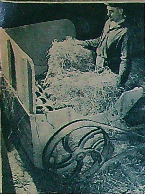
Halmen kommer direkt från åkern och rivs i en specialkonstruerad rivare. Med en matningskratta förs den i maskinen
