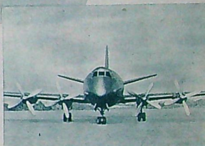
Bild framifrån, visande de dubbla hjulen och det höga stjärtparti, vilket gör ytterligare frimning överflödig vid ändring av motorsstyrka eller utfällning av klaffar och landningsställ.
