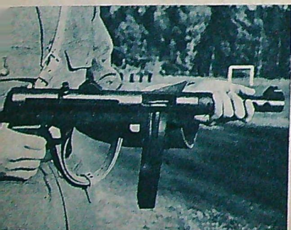
Så här skall Kpisten säkras när den är laddad. Då är den inte farligare än geväret.
