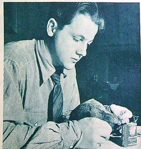
En intressant om också inte alla gånger effektiv metod att påvisa malm i ett malmprov är att låta två ledningar till ett ficklampsbatteri beröra stenen och vara kopplade till en glödlampa. Lyser lampan finns det elektricitetsledande malm i stycket.
