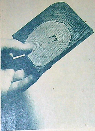
Detta Bolidenimpregnerade furustycke visar att saltet tränger igenom splintveden men spridar vid kärnan. Denna innehåller hartser som i sig själva skyddar mot skada.
