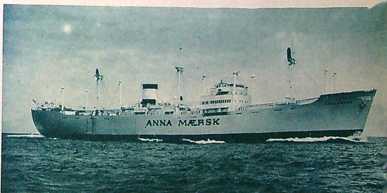
Ett vackert arbete från Eriksberg: Instmotorfartyget »Anna Mærsk», som levererats till ett danskt rederi. Fartyget är på 9.940 ton, har en 9-cylindrig motor, är 135,6 meter långt och gör normalt 16,5 knop. Bra fart!
