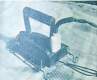
Det här gamla stryckjärnet är både omodernt och farligt. Skyddshylsan saknas, stiftet är söndergått och ligger öppet för beröring, och metallspiralen åter för- eller senare upp sladden. Kan orsaka kortslutning.
