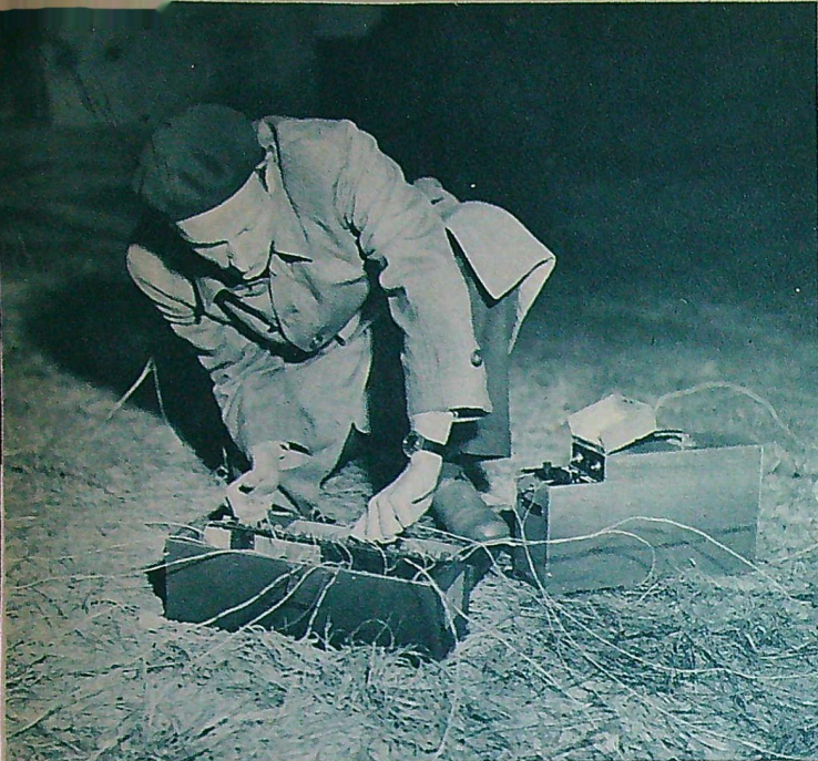
Kandidat Ulf Langefors med sin intervallkopplare. Den är försedd med ledningskontroll och rullar med ledningstråd som kan anslutas direkt till sprängkapslarna. T, h, tändaggregatet.
