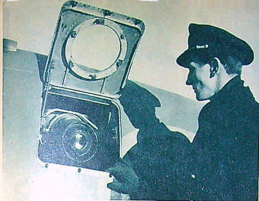
Med denna snedbildskamera kan man få läsbara bilder på tre mils avstånd. Kameran tar 250 bilder med 2-31 sek mellanrum.
