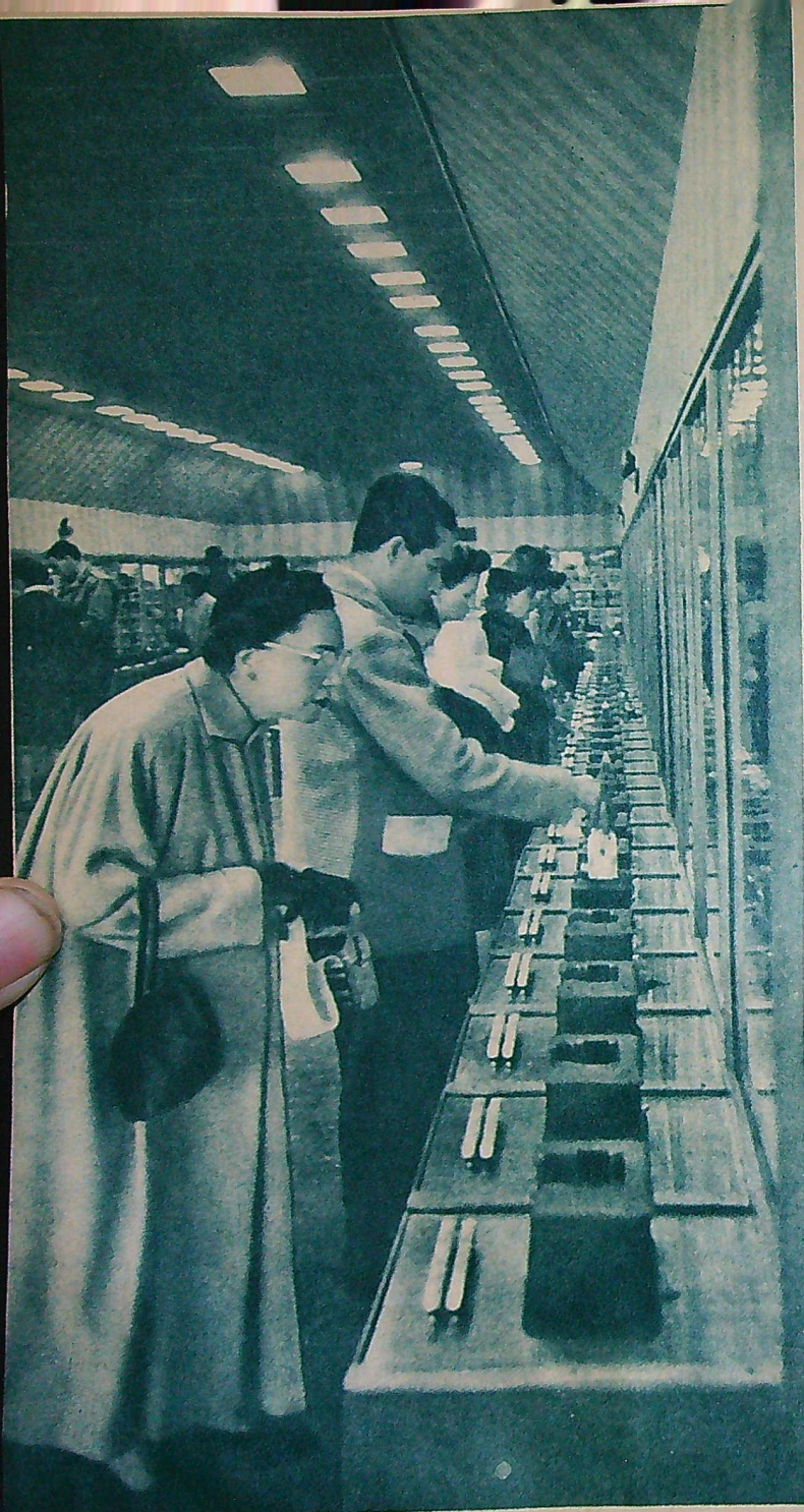
I den elektriska snabbköpsaffären betjänar man sig själv med hjälp av en nyckel. Varorna är utställda och numrerade i ett skyltskåp. Nyckeln släpps ned i apparaten framför skyltskåpen.
