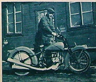
Främre delen av ramen måste byggas om för att få plats med den stora fyrcylindriga motorn.
