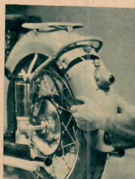
Bakstänkskärmen tas av. Obs. kontakten ovanför baklampan.
