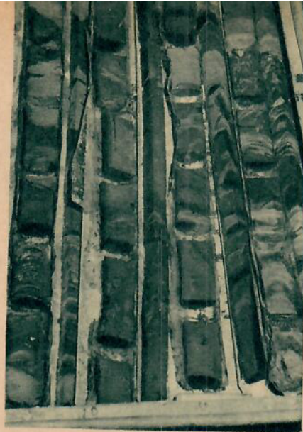
Sedimentprofiler hämtade ur havsbotten på 2.000—3.000 meters djup. Diametern är ca 7 cm, och en längd av 20 meter beräknar man motsvarar avlagringarna under 25 milj. år.
