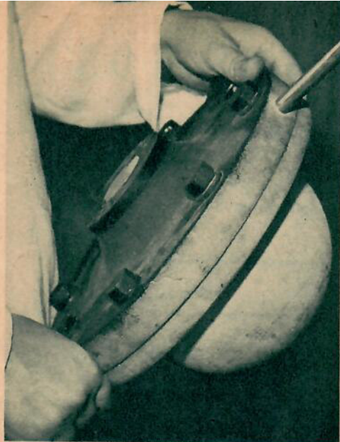
En djuphavsklocka avsedd för ljusmätning ned till 500 m djup. »Bomben» har ett 25 mm tjockt fönster av amerikanskt brandglas och innehåller både en kamera och urverk.
