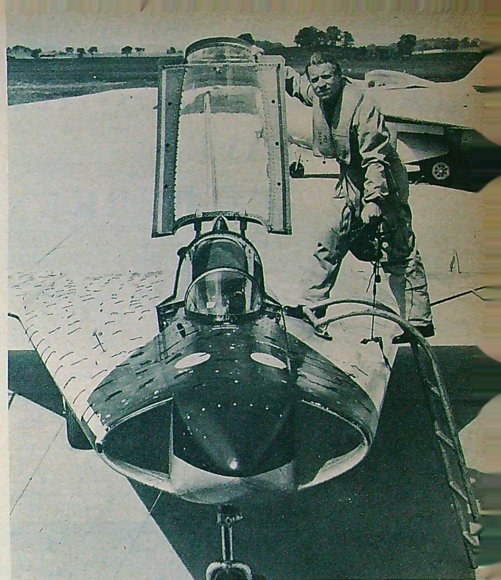
Ingenjör Bengt Olow gör sig redo att provflyga Saabs senaste skapelse. De mörka ränderna som framträder på högvingen är ultraräder vars uppgift är att vid filmning ge en uppfattning om luftströmmarna omkring planet. Dessa fotograferas av en kamera i fenan.
